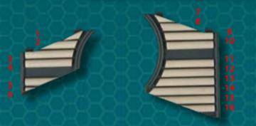
На схеме отмечен порядок установки элементов обивки. Шаги 1–8 показывают, как установить элементы на малую панель соединения с коридором (слева). Используйте аналогичную технологию для сборки большой панели (справа).
